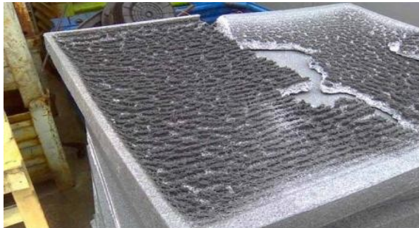
Obr.1 – důsledky špatného skldování šedého EPS
